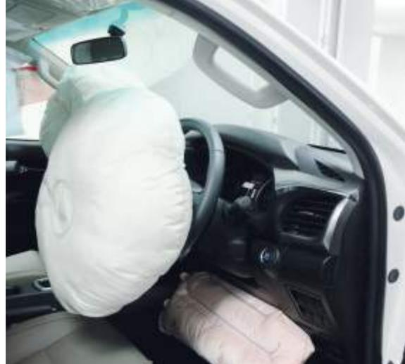
▲ Los airbags son un dispositivo de seguridad formado por una bolsa que se almacena en el volante, y está diseñado para inflarse rápidamente en caso de un accidente para amortiguar el golpe.
