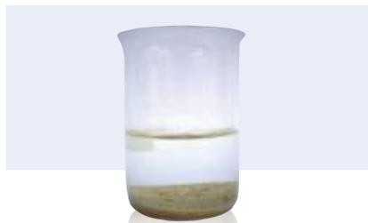
El sólido (arena) se deposita en el fondo del vaso de precipitado y el líquido (agua) queda por encima del sólido.
