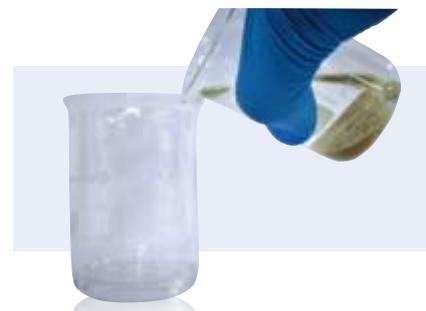
Se extrae el líquido (agua) inclinando el vaso de precipitado con cuidado y recolectando en otro recipiente.
