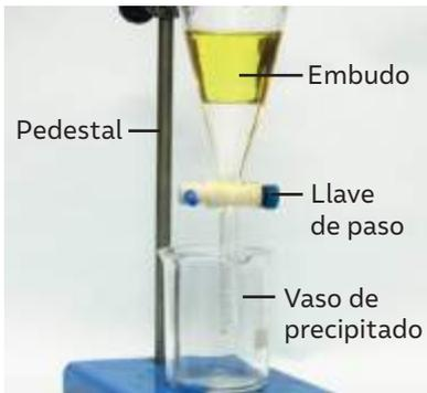
El líquido de mayor densidad (agua) queda en la parte inferior y el de menor densidad (aceite) en la parte superior del embudo de decantación.
