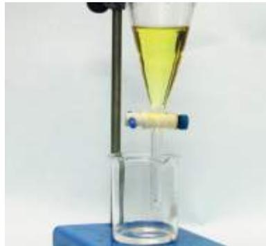
Abriendo la llave del embudo de decantación, el líquido de mayor densidad (agua) es recolectado en un vaso de precipitado.
