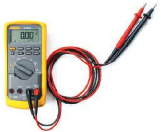
▲ El multímetro es un instrumento que permite medir las distintas magnitudes eléctricas que forman parte de un circuito. Además, mide potencias, resistencias, capacidades, etc.
