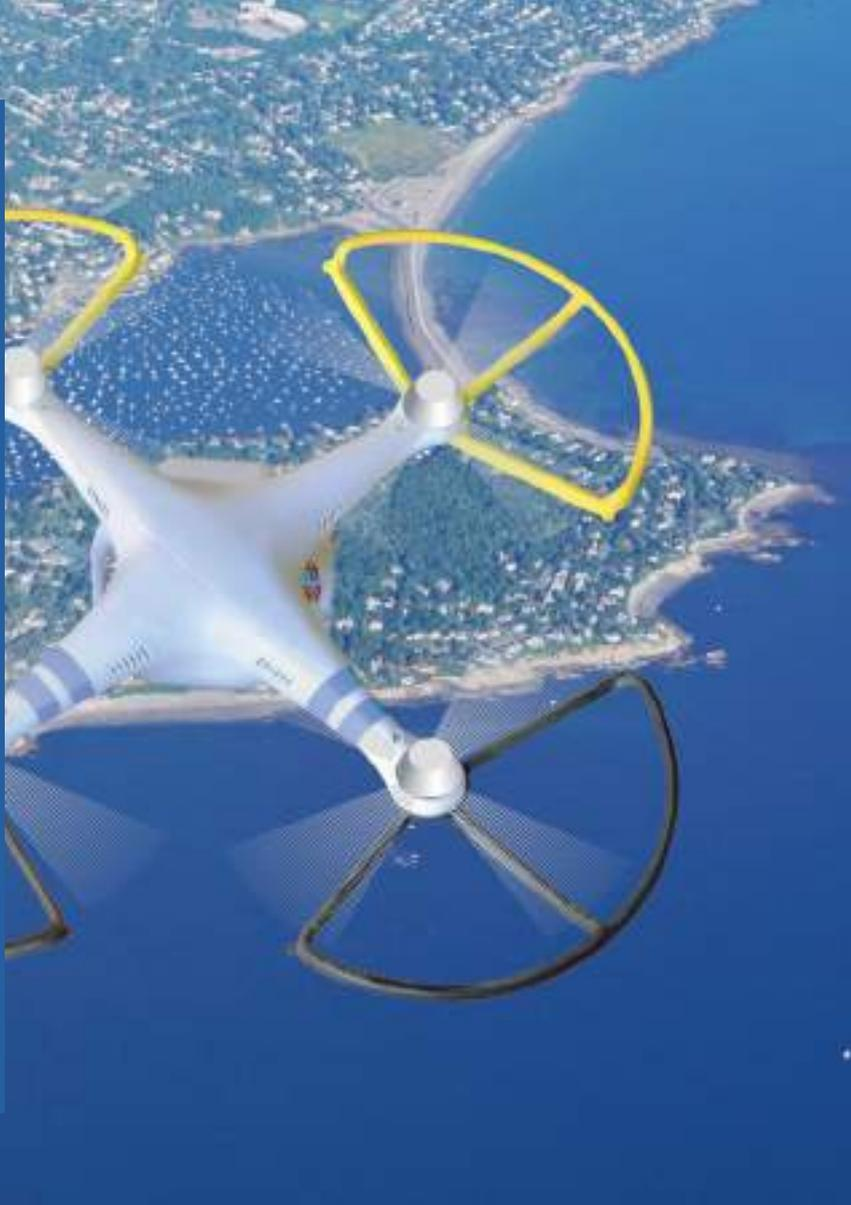
Un dron de vigilancia es un vehículo aéreo no tripulado que puede programarse para realizar rutas específicas en horarios determinados. Estos dispositivos pueden ser controlados de forma remota y están equipados con cámaras de alta resolución que transmiten imágenes nítidas en tiempo real. Su uso abarca desde la seguridad en rutas terrestres y marítimas hasta la protección de hogares, recintos privados e incluso la asistencia para los cuerpos de seguridad.
