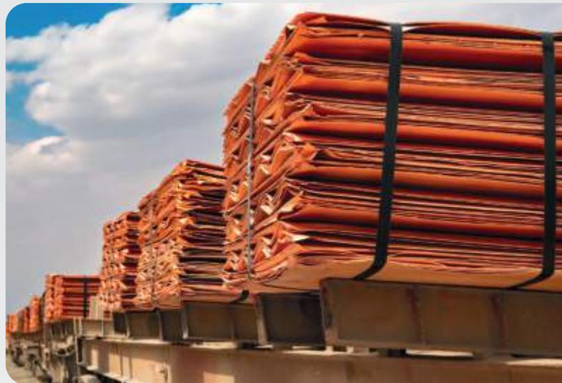
▲ Cátodos de cobre (99,99 % de cobre)
