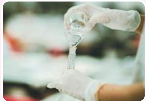
d. Con la piseta, completa con agua destilada hasta el volumen requerido (100 mL). En el matraz de aforo, la medida está marcada con una línea en la parte más delgada de éste. Recuerda que el menisco del líquido debe estar a ras de la medida.
