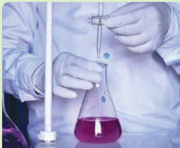
▲ En la imagen, se observa la titulación ácido-base utilizando como indicador la fenolftaleína que permite identificar soluciones básicas.
