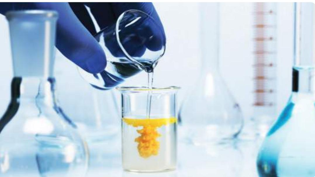
◀ Formación del precipitado diyoduro de plomo ( $PbI_2$ ) de color amarillo tras la reacción entre yoduro de potasio (KI) y nitrato de plomo ( $Pb(NO_3)_2$ )
